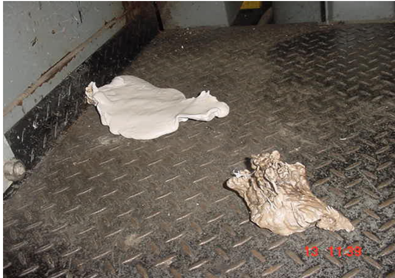
Figura 10 – Borras separadas durante a injeção.
