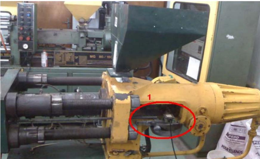
Figura 26: Unidade de Injeção da máquina injetora Semeraro 1978
