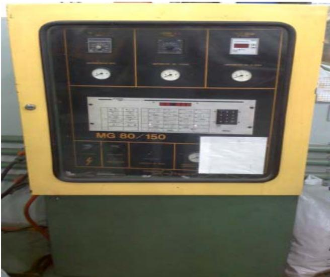
Figura 28: Painel de aquecimento da Injetora MG 1986
