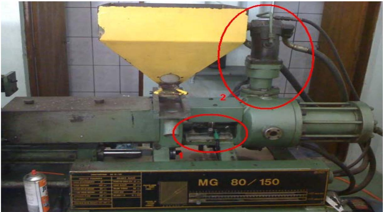
Figura 29: Unidade de injeção da injetora MG 1986
