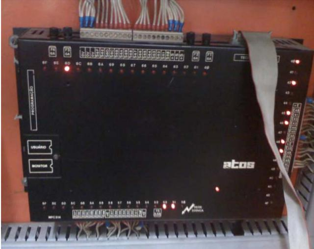
Figura 30: CLP ( Controlador Lógico Programável ) de fabricação atos
