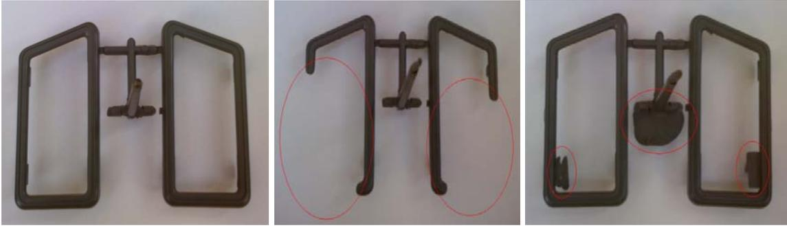
Figura 22: Peças fabricadas pela injetora mula manca
