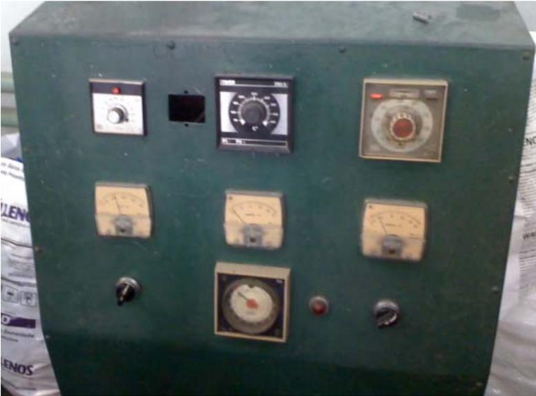
Figura 24: Painel de aquecimento da máquina injetora Semeraro 1978
