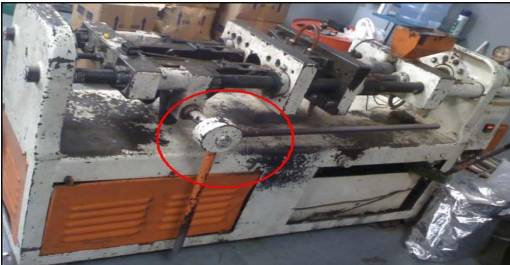
Figura 7: Sistema de fechamento mecânico de uma injetora mula manca
